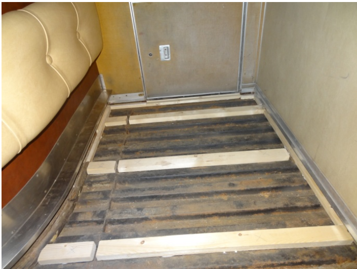
Disposición de listones en entramado y bordes
